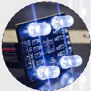
Detecta y distingue diferentes colores en su entorno. Se emite luz hacia el objeto o superficie que se desea analizar.
